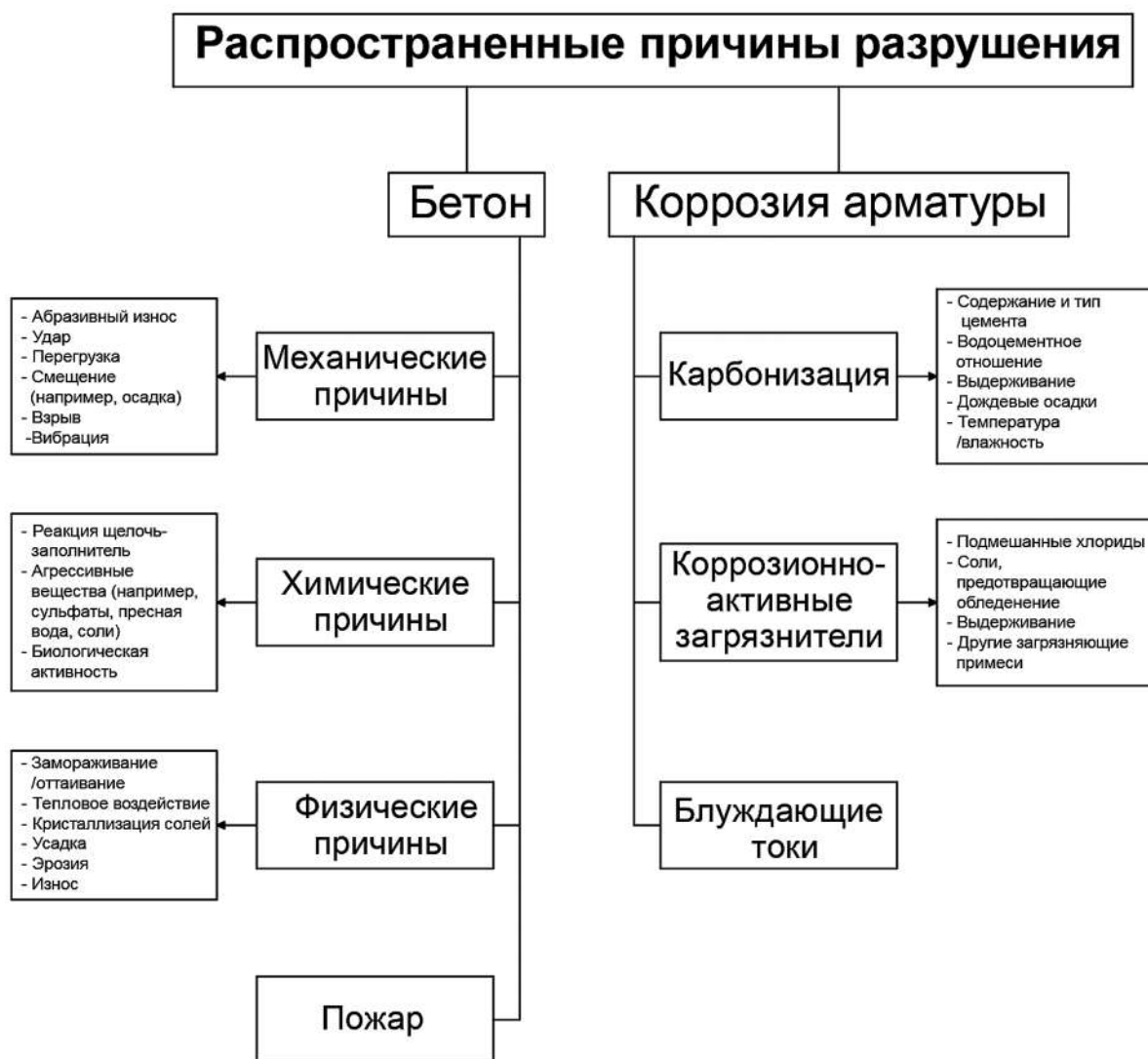
Рисунок 5.2 – Распространенные причины разрушений конструкций
