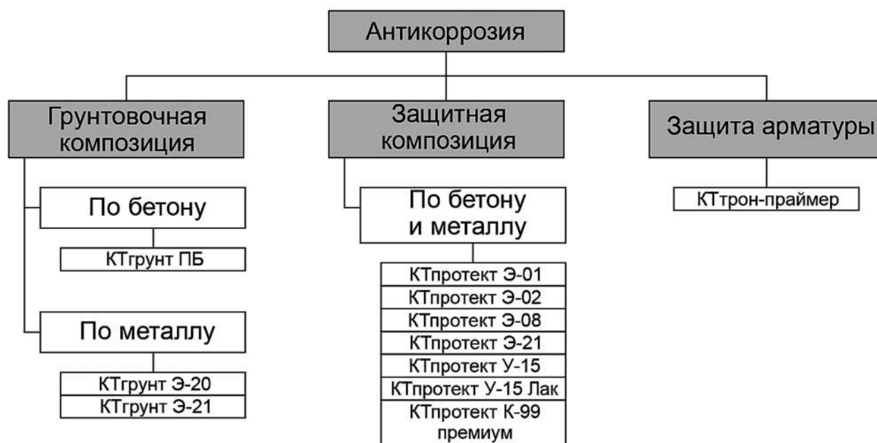
Рисунок 4.2 – Схема классификации антикоррозионных материалов «КТТрон»
