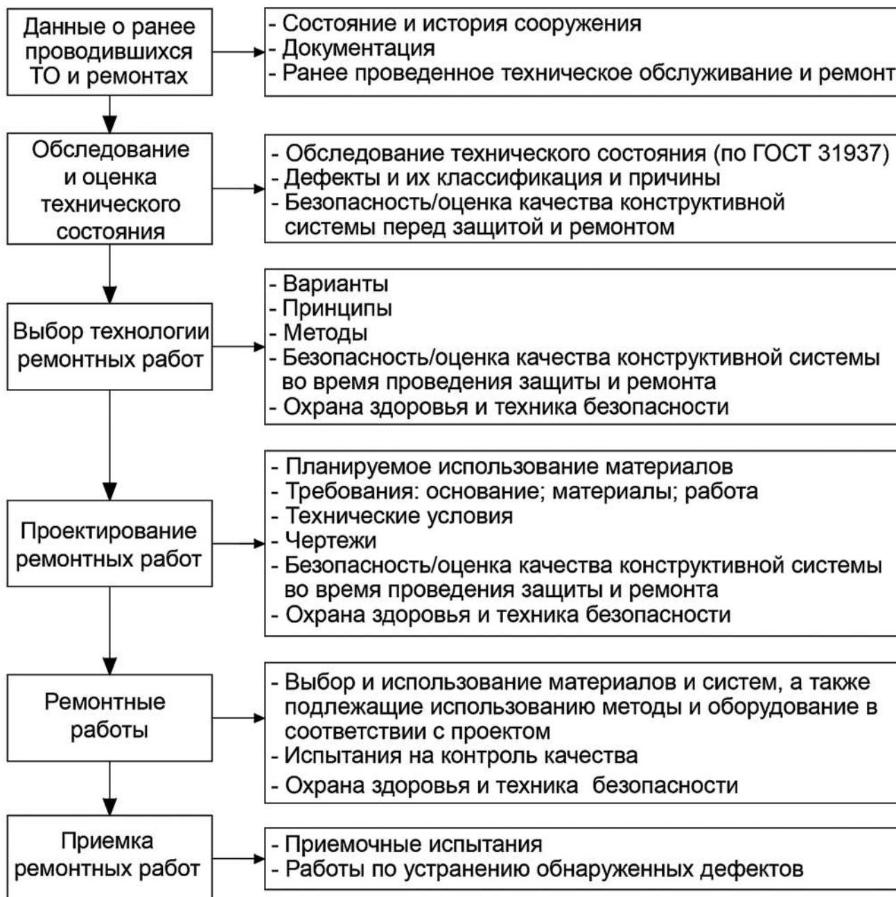
Рисунок 5.1 – Этапы стандартного проекта по ремонту
